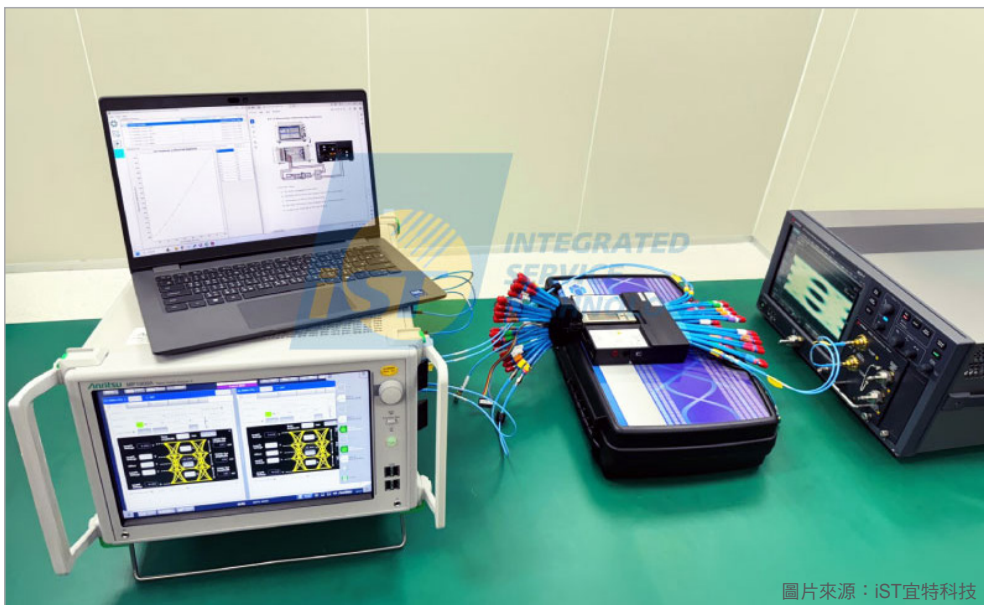
圖2 100GAUI C2M Host RX訊號校正時的環境
