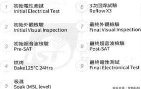
圖1 MSL試驗流程步驟
